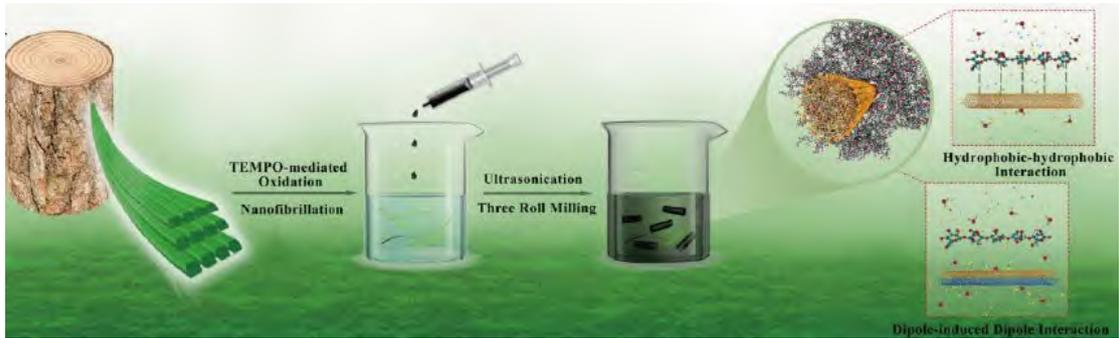
2. 碳纳米管的分散。将 SWNT 粉末超声分散到 CNF 悬浮液中 10 分钟。然后使用 TRILOS TR80A 三辊机，通过将间隙从  $10\ \mu\text{m}$  控制到  $1\ \mu\text{m}$ ，研磨 20 分钟来进一步分散。利用了相邻旋转辊间的高强度应力，以及间隙的逐渐减小，分散 SWNT 到浓度为 1wt% 的 CNF 悬浮液中，获得 CNF/SWNT 悬浮液。
