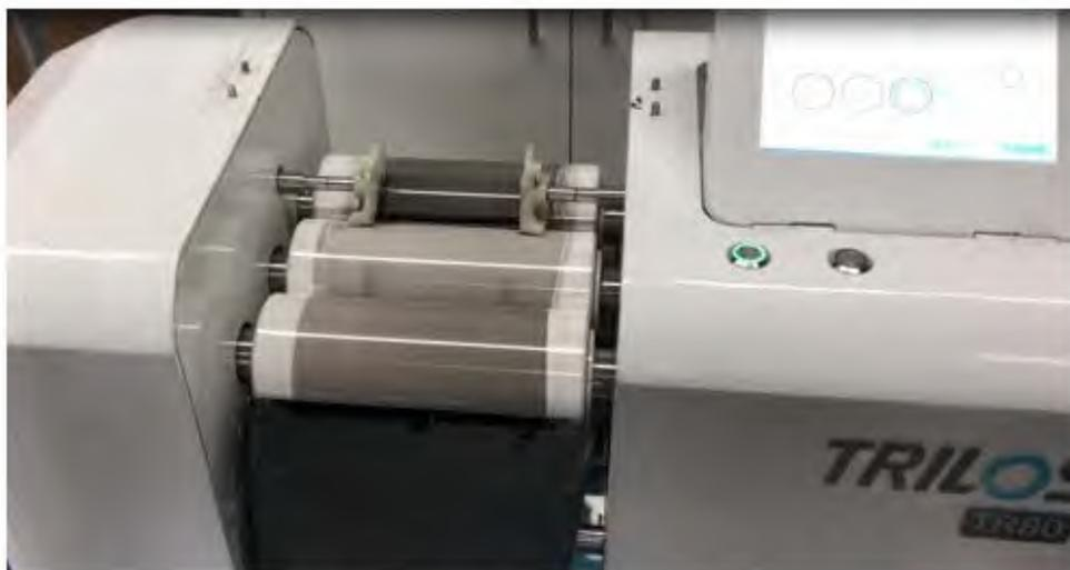
TRILOS TR80A 三辊机研磨分散 CNF/SWNT 悬浮液
