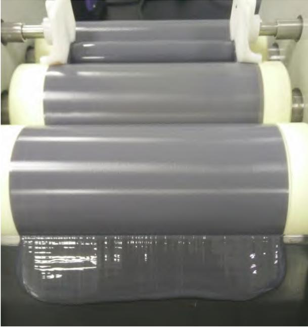
观察效果: 流动性初步改善, 细度测得 12u。说明通过剪切后物料被深度混合, 且出现小面积分散现象。
