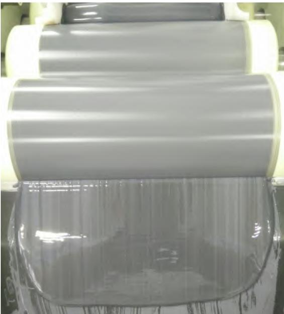
观察效果：物料出料均匀，表面出现分散变细后张力形成的条状斑纹，最终细度测得为 5 $\mu$ m，目标达成。
