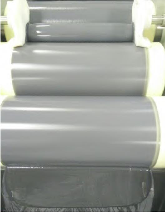
观察效果：流动性达到最佳，细度测得 7 $\mu$ m。物料大面积分散现象已经出现，主要得益于转速比的调节使物料得以均匀分散。
